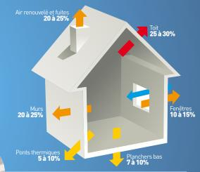
Grâce au rupteur, on neutralise la majorité des déperditions en bout de plancher
